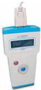
校准单元 使用内置电脑芯片校准气瓶的阀门
